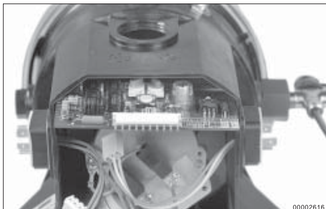
Abb. 16: - Steuerplatine im Gehäuse eingebaut
