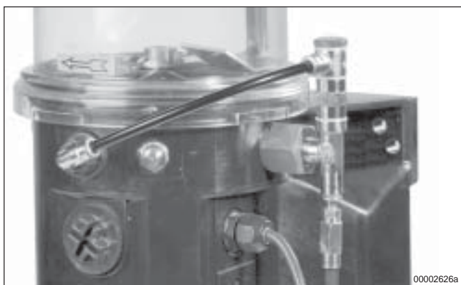
Abb. 13: - Druckbegrenzungsventil mit Fettrückführung
